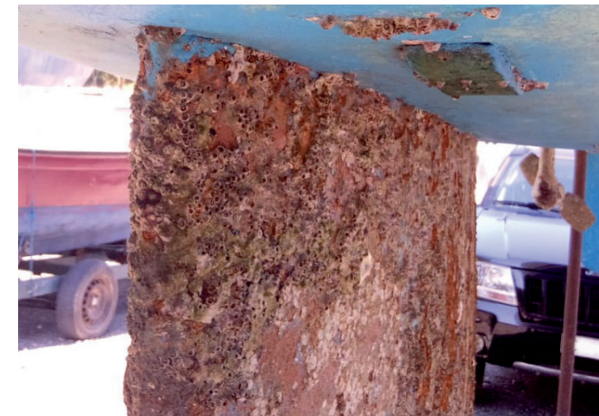
Balani e cirripedi (denti di cane) e corrosione parti metalliche (deriva e passascafi).
