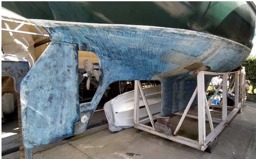
Uno scafo di trent'anni in poliestere rinforzata con fibre di vetro realizzato con laminazione manuale.
