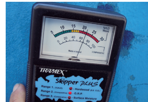
Due igrometri che presentano valori elevati di umidità a scafo. Skipper Plus del marchio Tramex e Skinder del marchio Cecchi.
