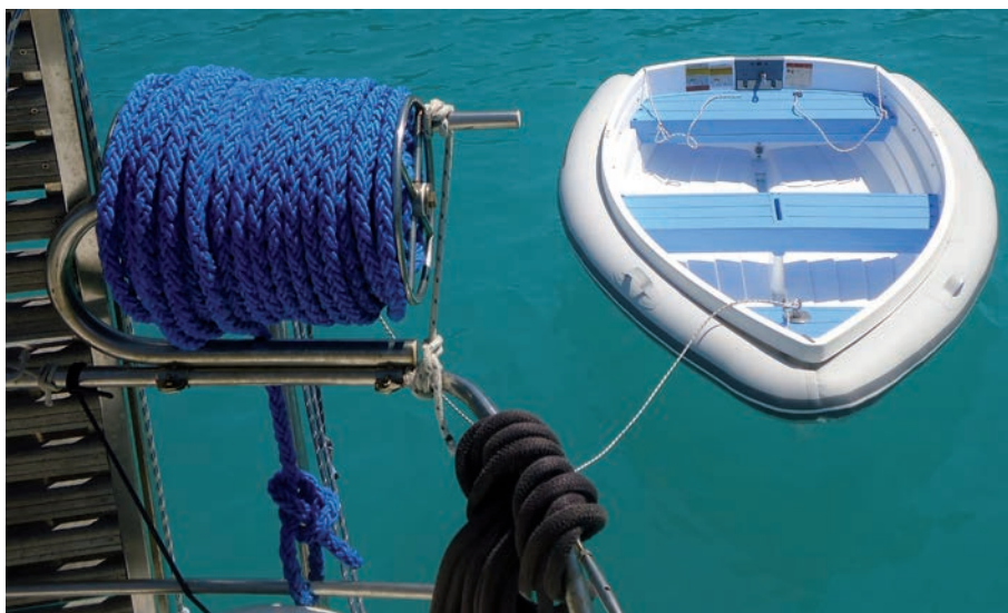
Figura 7 Ghindaro con cavo galleggiante fissato (con morsetti) sul balcone di poppa di Gemma.
