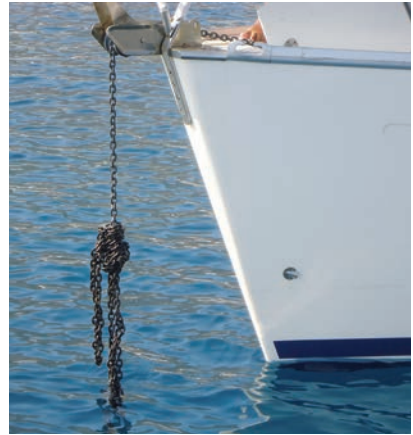
Figura 4 Catene incattivate di due imbarcazioni affiancate alla fonda (rada di Livadhi a Tilos, Grecia).
