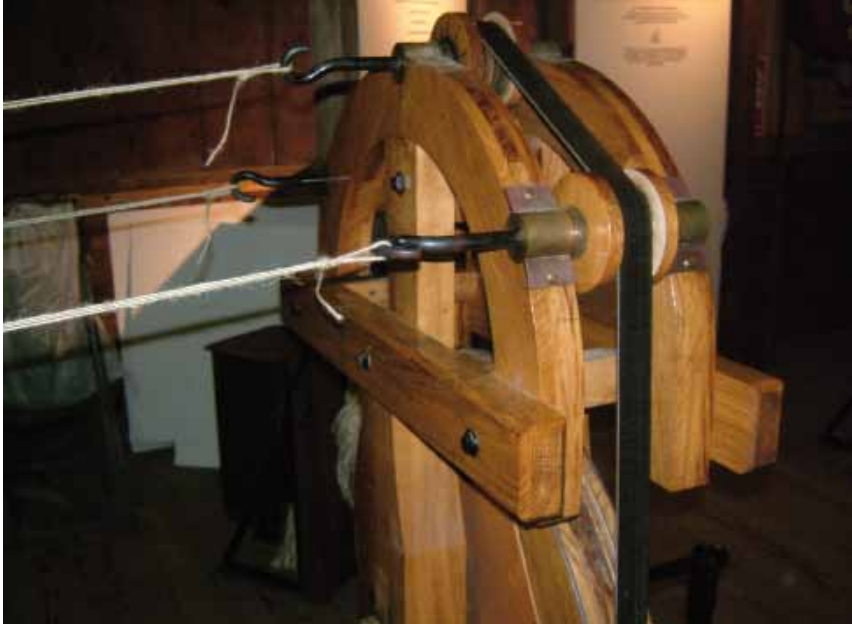
Figura 1.2 Fabbricazione delle corde ritorte.
