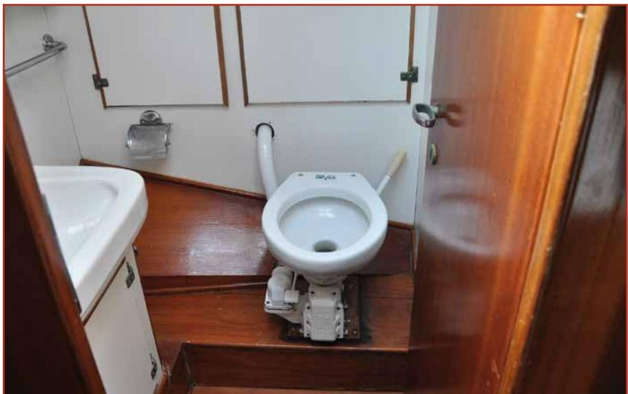
**Foto 2** Il locale WC della cabina degli ospiti su uno scafo d'epoca di generose dimensioni. Si noti l'essenzialità dell'impianto, associato però a un'ampiezza da ritenersi notevole per l'epoca, caratteristica resa possibile proprio dall'importante lunghezza della barca.
