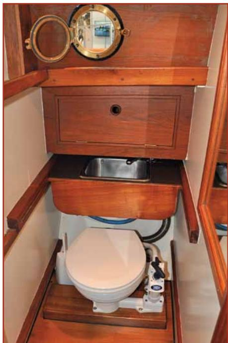
**Foto 1** Il locale toilette su un'imbarcazione d'epoca o classica. Si noti come lo spazio sia particolarmente angusto e ricavato all'interno di un ambiente equivalente a quello di un armadio. Il lavello scorre su due binari per essere riposto quando non in utilizzo e permettere l'accesso al WC: ne risulta che non è possibile l'uso contemporaneo delle due strutture.
