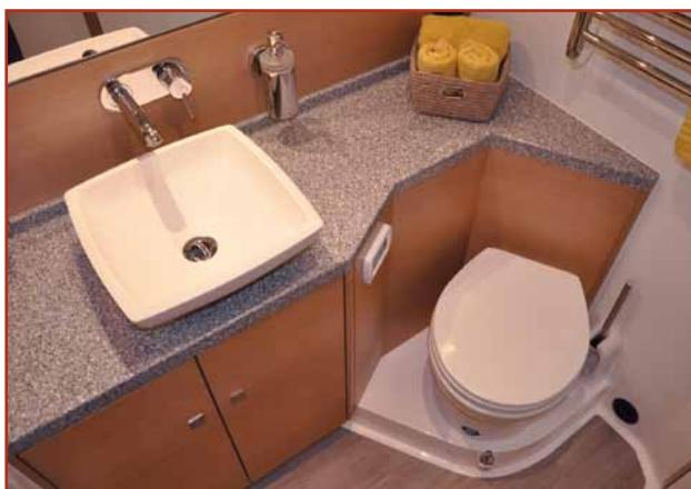
**Foto 3, 4 e 5** Moderni locali WC su imbarcazioni a vela di 12-15 metri. A seconda delle scelte del cantiere, delle preferenze dell'armatore e dell'uso armatoriale o charter, il WC può essere manuale o elettrico.
