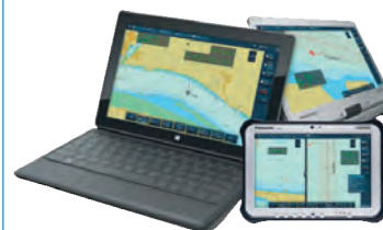
Figura 14.3 - Un sistema ECS
