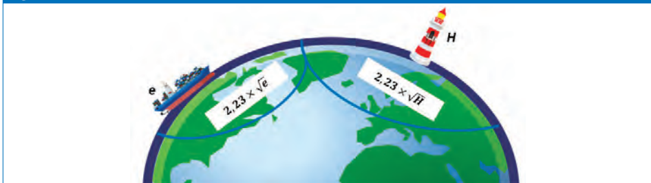
Figura 16.16 - Portata massima del radar
